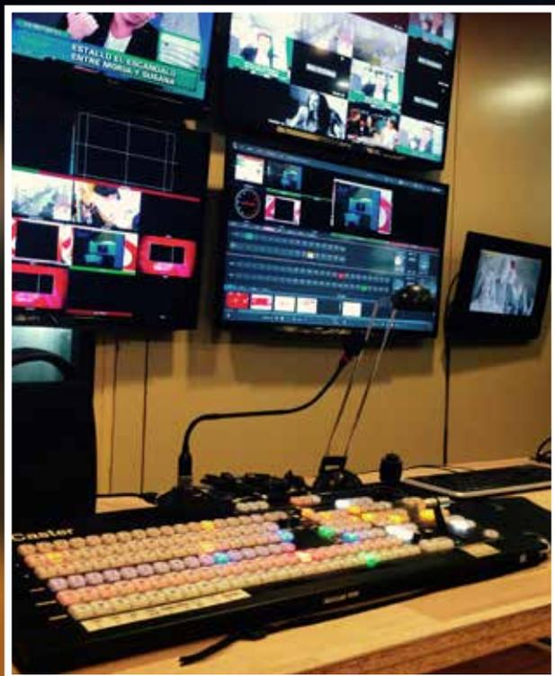
El equipo del Área Técnica ha trabajado en la implementación del Control de Producción en Full HD. Esto implicó un cambio radical que incluyó la renovación de las cámaras en piso, el switcher master y los elementos gráficos. Además, se produjo un avance en el concepto de la iluminación, la cual se suavizó para mejorar la piel de los conductores y permitir que se inserten mejor en la escenografía virtual.
